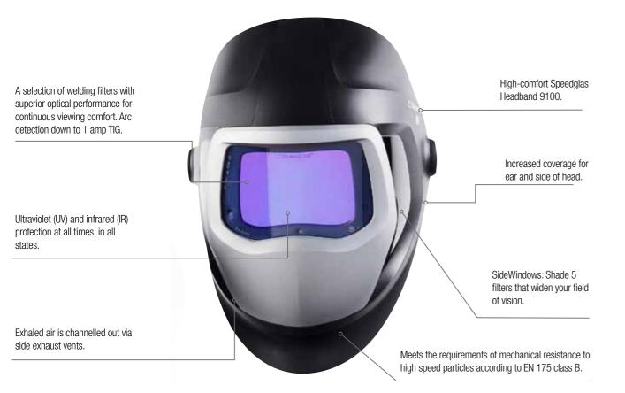
3M<sup>™</sup> Speedglas<sup>™</sup> Welding Helmet 9100 Air
